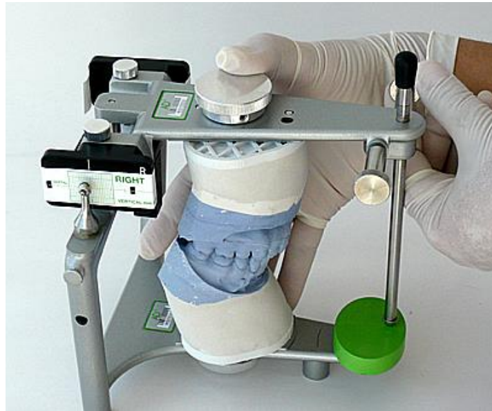
Fig. 8. La cera estará correctamente desgastada cuando la altura del pin en OC no varía, estando o no la cera interpuesta entre los modelos.
